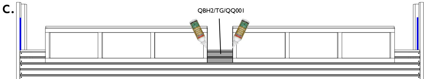
**NL:** Bevestig aan de binnenkant het raam door de groef aan de tand van de kleine stukken. Zorg er voor dat de onderzijde van het raam mooi overloopt in de lijn van de kleine stukken. Vergeet hier zeker niet voor te boren!
