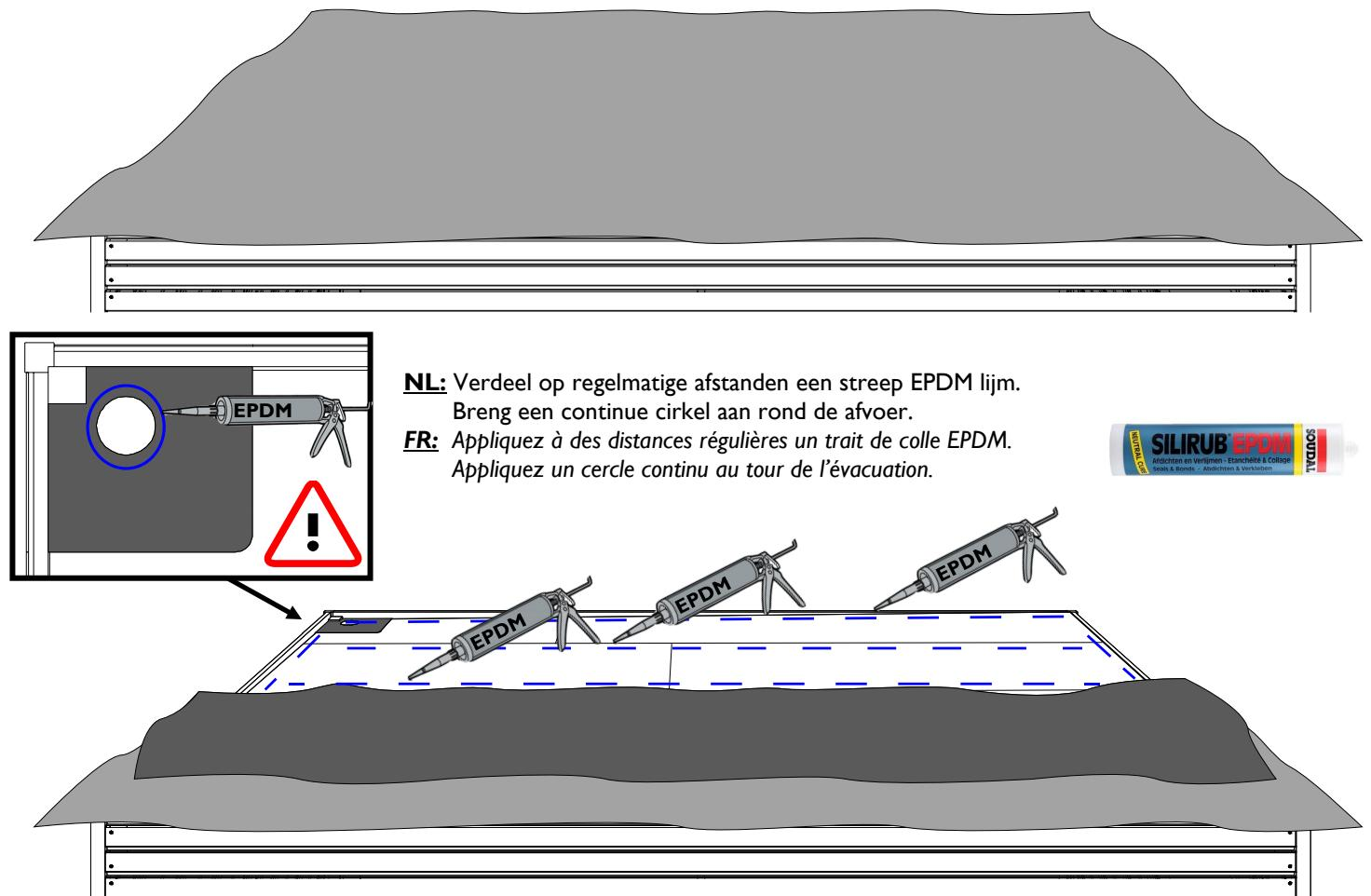
**NL:** De EPDM voor garage en extensie(s) bestaat uit verschillende vellen, lijm deze aan elkaar met een volle, continue streep lijm.
